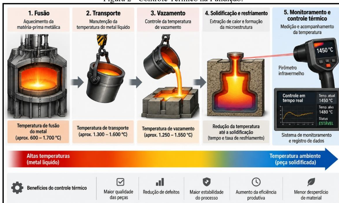
Figura 2 - Controle Térmico na Fundição.
