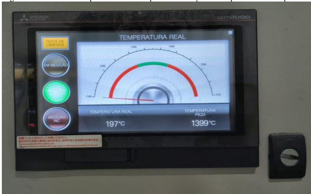
Figura 10 - Interface de supervisão utilizada para visualização da temperatura real do processo.
