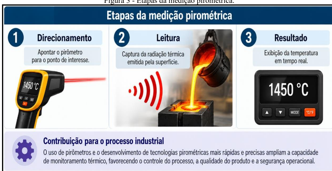
Figura 3 - Etapas da medição pirométrica.
